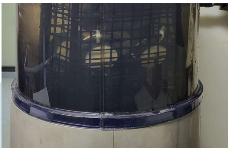
Figure 2 : POCIS mis en place pour suivre les eaux brutes
